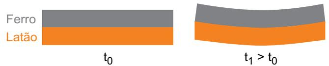
Considere um par bimetálico constituído por duas lâminas, cada uma com comprimento 5,0 cm, sendo uma lâmina de ferro e outra de latão, cujos coeficientes de dilatação linear valem, respectivamente,  $1,2 \times 10^{-5} \text{ }^\circ\text{C}^{-1}$  e  $2,0 \times 10^{-5} \text{ }^\circ\text{C}^{-1}$ . Se essas duas lâminas têm o mesmo comprimento quando a temperatura é de  $20 \text{ }^\circ\text{C}$ , a diferença de comprimento entre elas na temperatura de  $70 \text{ }^\circ\text{C}$  é de
